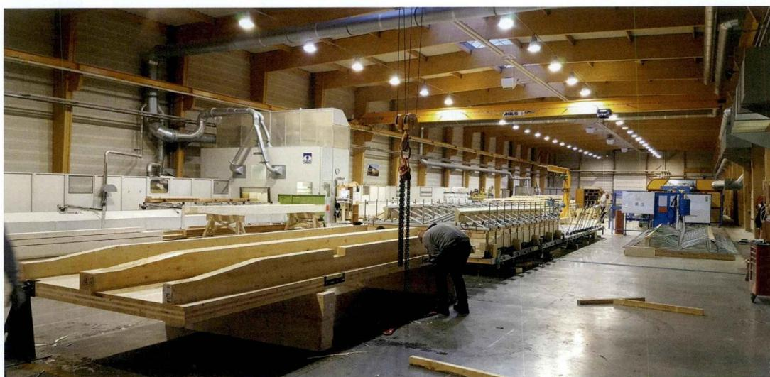
Au sein de son usine alsacienne, la société fabrique notamment le système constructif Azurtec®, permettant de mettre en œuvre des portées importantes pour la charpente, libérant les espaces intérieurs et offrant une grande modularité.
