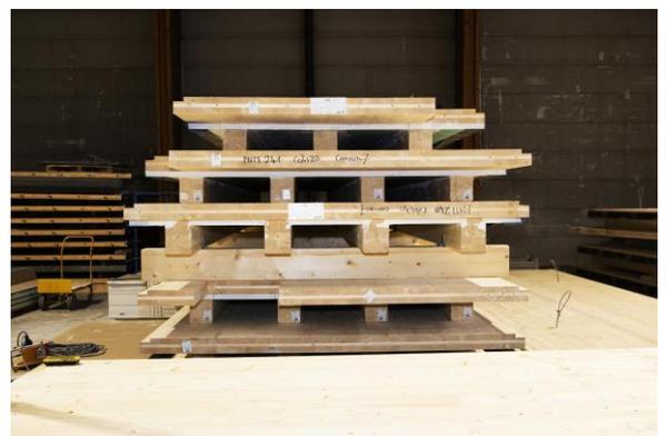
Système de plancher préfabriqué Azurtec® Placo®
